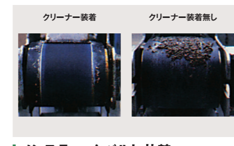
■ノンスティックベルト 比較 クリーナー装着 クリーナー装着無し
